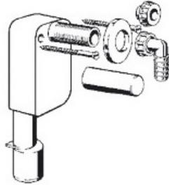
Wandsifon für die Entleerung des Dampfgenerators und des Duftdispensers
