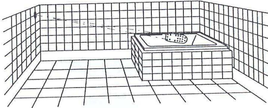
Hinter der Wandeinbaumuffe ein Leerrohr mit mindestens  $\varnothing 20$  mm zum steuerungsseitigen Wannbereich vorsehen. Steuerungsseitig ist für den IR-Empfänger-Anschluß ein kurzes Kabelstück mit vierpoligem Stiftkontakt-Gehäuse vorhanden.
