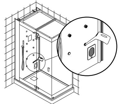
Prima di attivare il Riempimento, assicurarsi che il tubo di aspirazione sia inserito in un contenitore di profumo. Non appena il riempimento viene attivato con il tasto [ok], la procedura ha inizio. Il riempimento termina automaticamente quando il sensore interno indica che il contenitore del profumo è pieno.
