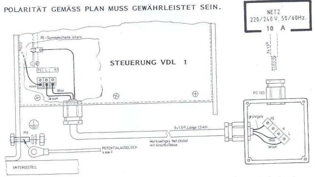
Potentialausgleich 4  $\mathrm{mm}^2$  an der gekennzeichneten Schraube unterhalb der Steuerung anschließen.
