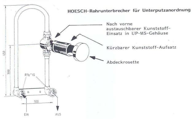
Bei Installation des Rohrunterbrechers <u>nicht</u> im Wannenbereich, ist unterhalb des Kunststoff-Aufsatzes ein Trichterablauf vorzusehen.
