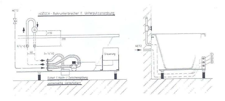
Zu empfehlen ist die Verwendung des auf das System abgestimmten "HOESCH-Rohrunterbrechers für Unterputzanordnung" (Art.-Nr. 6962) mit DVGW-Prüfzeichen.
