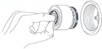
Durch Linksdrehung des vorne am Klemmring angesetzten Düsenschlüssels ist der komplette Abdeckring demontierbar. Der gesamte Düsen-Einsatz kann nun entnommen und in alle Komponenten zerlegt werden.
