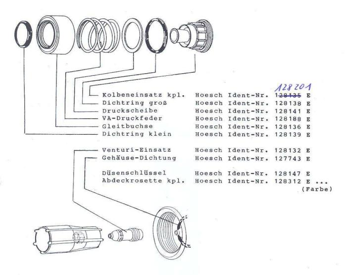
Weiter ist mit dem im Düsenschlüssel integrierten Innensechskant auch der Venturi-Einsatz aus dem Düsengehäuse ausschraubbar.
