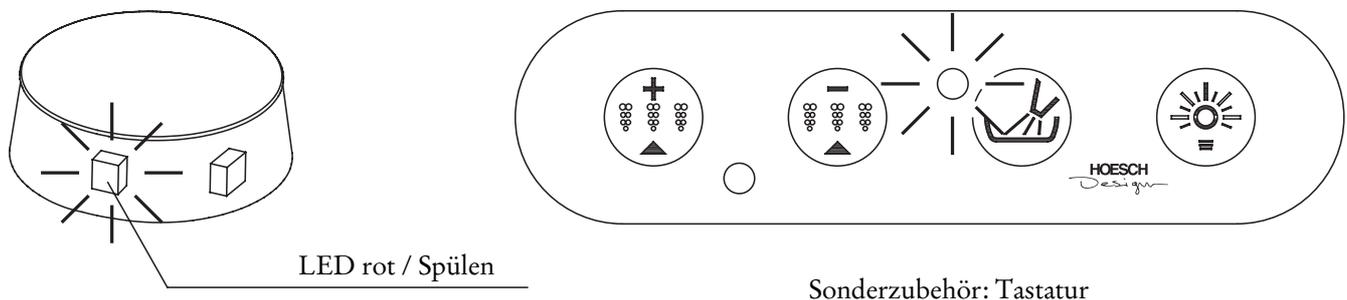
Eine Unterbrechung ist nicht möglich! Abgestimmt auf die zwei verschiedenen Whirlsysteme bedeutet dies: Air-Injection-System: Vorspülung: mittels frischen Füllwasser das durch die Luftkanäle direkt in den Ablauf geleitet wird. Nachspülung: mit Netzwasser, Desinfektionsmittel und anschließender Trocknung durch das Gebläse.
