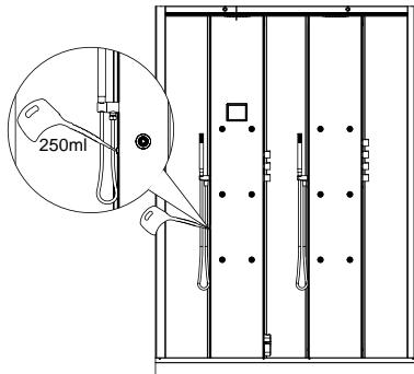
Pour le détartrage il faut mettre 250ml de Détartrant spécial HOESCH (HOESCH Spezial-Entkalker, Art.Nr. 692101) le réservoir et ensuite activé en poussant sur la touche (5).
