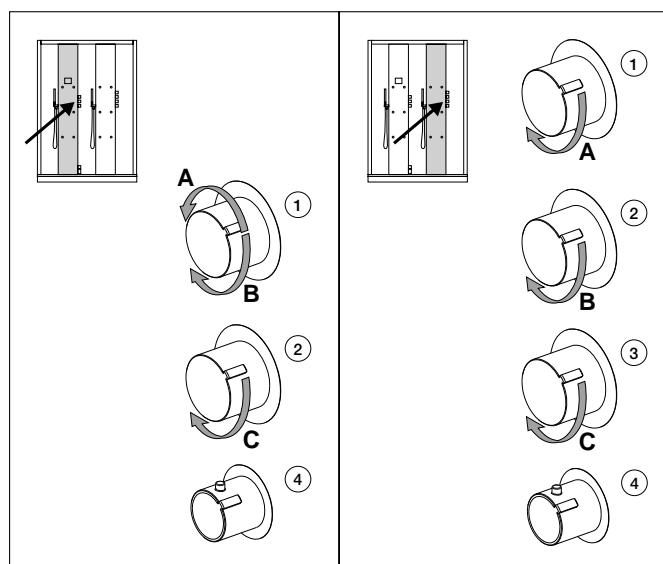
В случае дефектной регулировки температуры на 38°C нужно совершить калибровку терmostатического клапана в соответствии со следующими указаниями:
