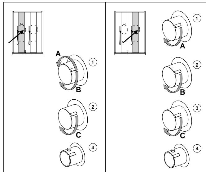
In caso di regolazione errata della temperatura dell'acqua a 38°C, regolare il termostato come descritto di seguito:
