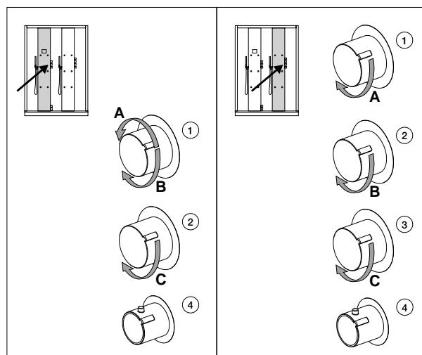
En caso de una regulación incorrecta de la temperatura del agua a 38°C, el termostato debe calibrarse siguiendo las siguientes indicaciones:
