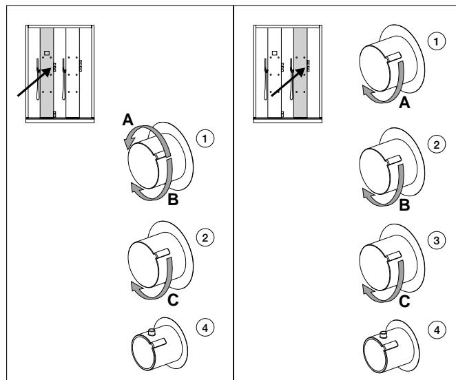
En cas de mauvaise régulation de la température de l'eau à 38 °C, le thermostat doit être calibré, conformément aux instructions suivantes :
