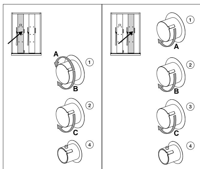
在温度控制不正确的情况下，恒温器应根据下面的说明以38°C校准：
