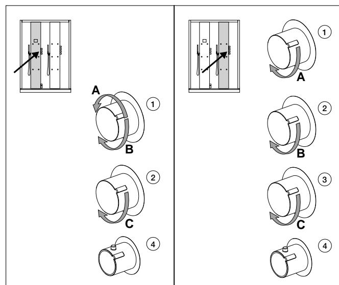
Im Fall falscher Wassertemperaturregulierung von 38°C sollte der Thermostat gem. folgender Anweisung kalibriert werden:
